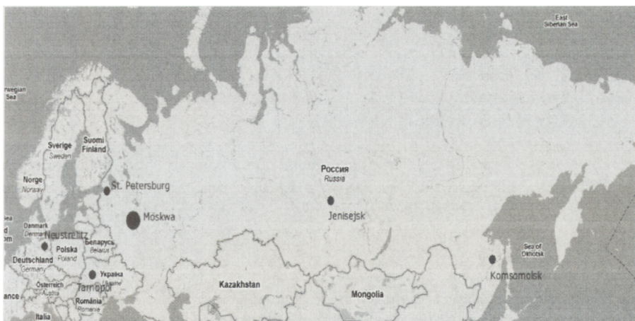
Rys. 7. Rozmieszczenie stacji kontrolnych systemu GLONASS
