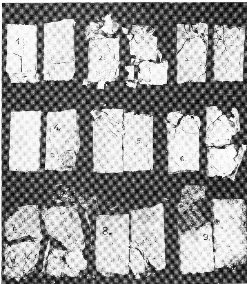
Fot. Stan zachowania zapraw po 9 cyklach
