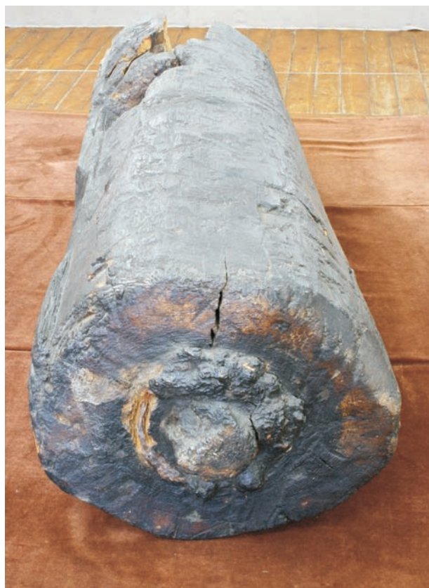
Ryc. 4. Fragment rury wodociągowej z żelaznym łącznikiem (buksa). Muzeum Historii Miasta Lublina. Fot. P. Rutkowski.
