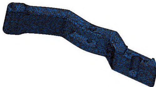
Rys.18. Model szczęki z nałożoną siatką elementów skończonych
