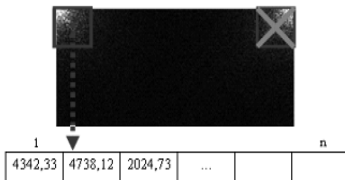
Rysunek 3. Przepisanie wartości współczynników macierzy przekształcenia 2D-DFT z kwadratowej macierzy o rozmiarze 8x8 do tablicy jednowymiarowej
