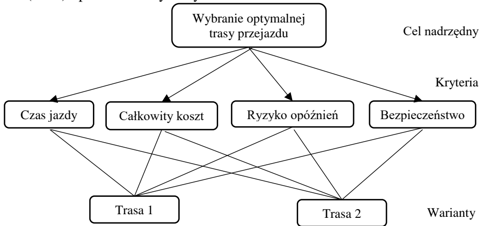
Rysunek 1. Schemat struktury hierarchicznej zadania wyboru trasy dla ładunków niebezpiecznych
