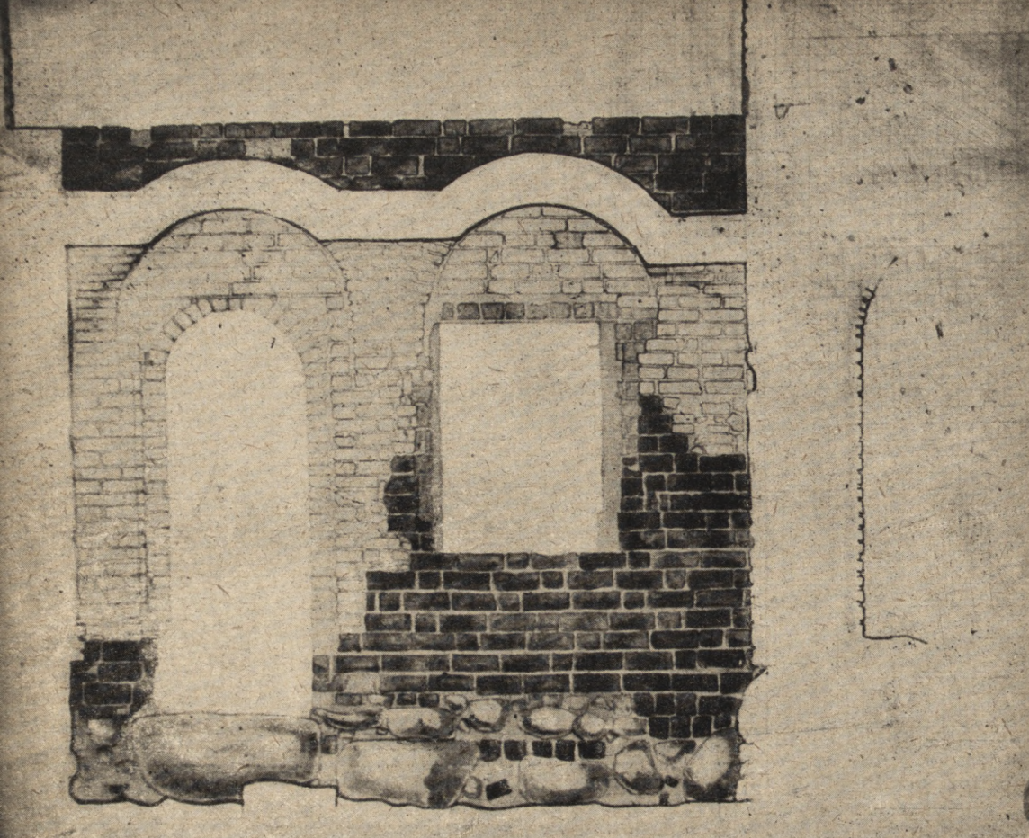
Ryc. 210. Inwentaryzacja muru w kamienicy przy ul. Brzozowej 7. Widoczny wątek gotycki zachowanych szczątków muru obronnego.
