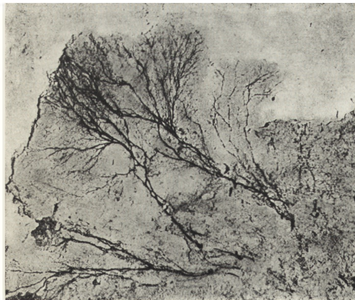
Ryc. 6. Pyzdry, klasztor, nitki grzyba między warstwami tynków i pobiał (pod malowidłem Matka Boska Bolesna, scena 22) (fot. H. Grzesikowa)
