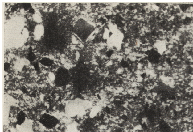
8. Kornatka, pow. Myślenice, obraz szlifu ceramiki średniowiecznej, pow. ok. 50 \times mik+
