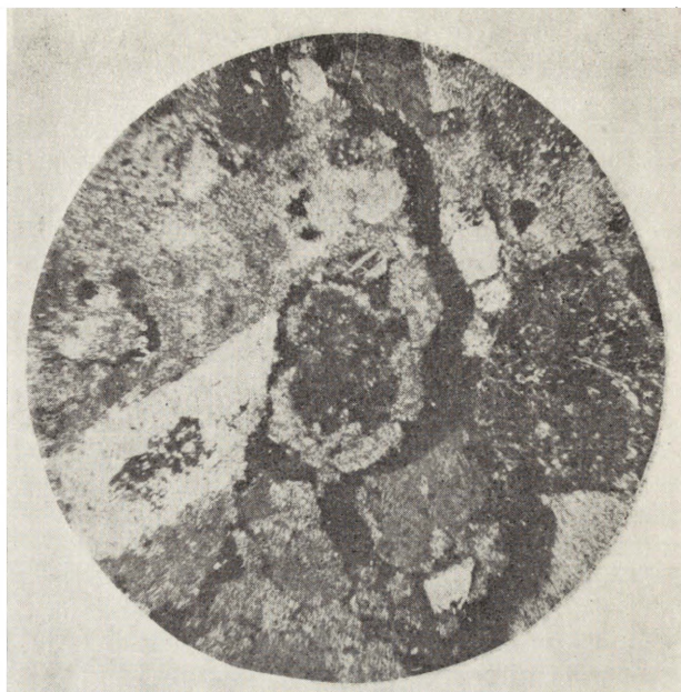
9. Obiekt nr 6, druga warstwa zaprawy \text{CaCO}_3 z wypełniaczem (tuf wulkaniczny); zdjęcie mikroskopowe szlif w świetle przechodzącym (fot. G. Korpala)
