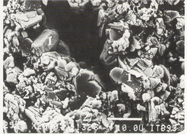
8. Mikroobszar charakterystyczny dla zaczynu o proporcji gipsu do kalcytu 5,2:1, powierzchnia przelomu próbki nr 6, SEM, powiększenie 2000x: 1 — gips, 2 — kalcyt
