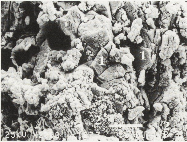
7. Mikroobszar charakterystyczny dla zaczynu o proporcji gipsu do kalcytu 2,4:1, powierzchnia przelomu próbki nr 1A, SEM, powiększenie 2000x: 1 — gips, 2 — kalcyt
