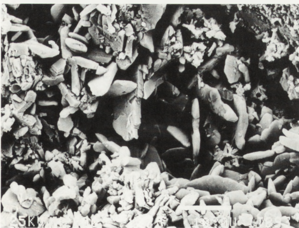
5. Mikroobszar złożony głównie z kryształów gipsu, powierzchnia przelomu próbki nr 1B, SEM, powiększenie 2000x
