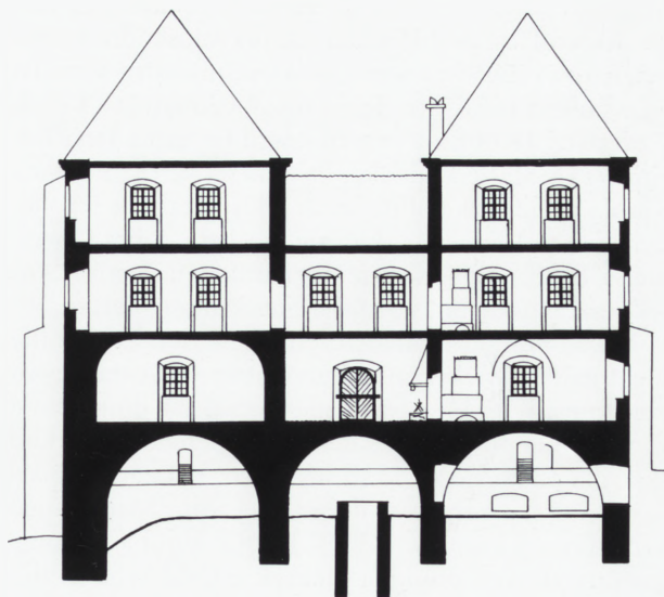
5. Zamek po przebudowie Opalińskich, przekrój poprzeczny — rekonstrukcja autora
