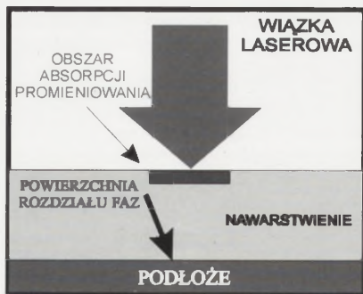
12. Zobrazowanie czyszczenia zabrudzonych powierzchni za pomocą impulsu laserowego o dużej gęstości mocy 12. Depiction of cleaning a surface with the aid of a large power density laser pulse
