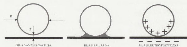
14. Główne siły adhezji (przylegania) mikroskopijnych cząsteczek zalegających na powierzchniach podłoży
