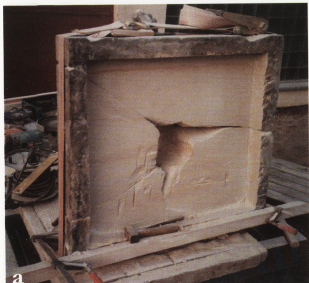
4. Rzeźba Ateny: a — płyca wydrążona w części spodniej podstawy rzeźby; widoczne wyrażnie płaszczyzny podziału zgodne z promieniowym kierunkiem działania sił przyrostu objętości korodującej stali. Fot. W. Procyk; b — propozycja zespolenia popękanej podstawy rzeźby i ustabilizowania ciężaru kompozycji na nowych elementach z piaskowca wklejonych w jej wydrążone wnętrze
