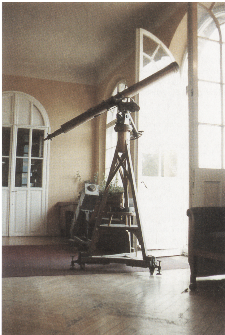
Rys. 6. 11.6 cm refraktor Mertza z Obserwatorium Krakowskiego. (Fot. J. W. Mietelski).
