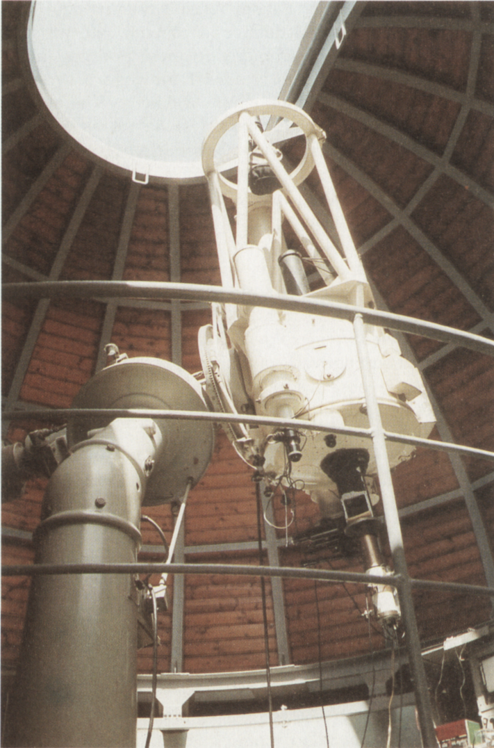
Rys. 9. 50 cm reflektor Cassegraina z Obserwatorium Krakowskiego. (Fot. J. W. Mieltski).
