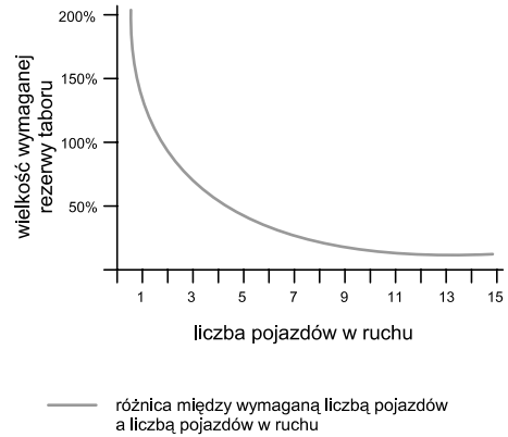
Rysunek 5. Liczba posiadanych pojazdów kolejowych w zależności od liczby pojazdów w ruchu
