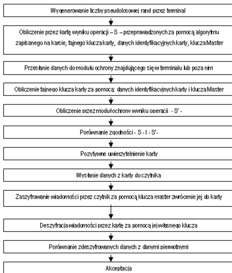
Rys. 1. Procedura uwierzytelniania karty za pomocą systemu symetrycznego
