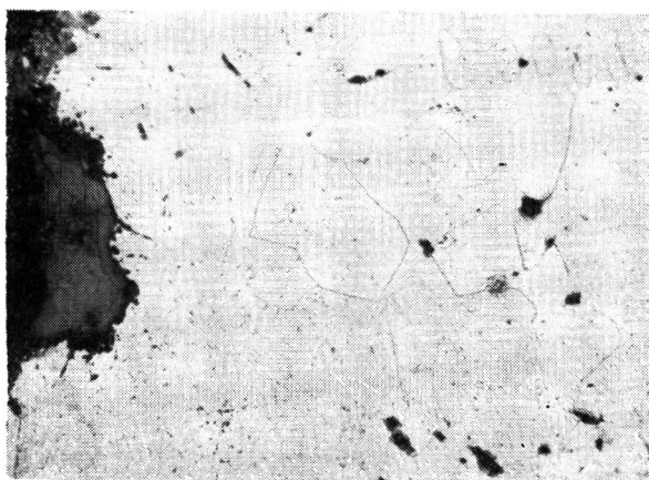
Rys. 9. Struktura obok otworu (próbka nr 1), zgląd poprzeczny wycięty z przedmiotu żelaznego nr 1. Otwór znajduje się z lewej strony mikrofotografii. Na ścianie otworu widoczna warstewka rdzy. Traw. azotol, pow. 100 razy.
