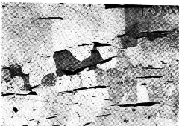
Rys. 16. Struktura ferrytyczna próbki nr 5, zgląd poprzeczny, traw. azotol, pow. 100 razy.
