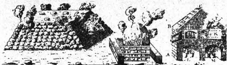
Rys. 1. Sposoby prażenia rud metali i wychwytywania siarki wg Lomonosowa Рис. 1. Способы обжига металлов и извлечения серы (по Ломоносову). Fig. 1. Methods to reduce metal ores and isolating sulphur after Lomonosov
