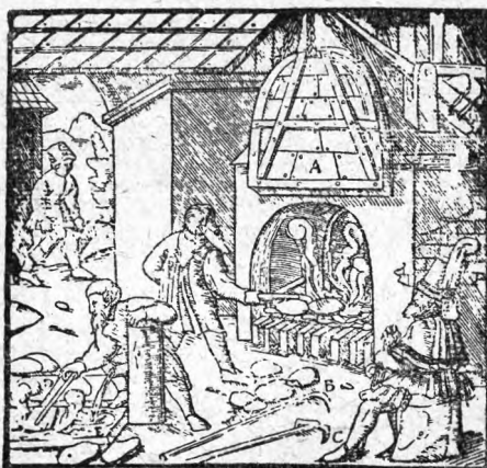
Rys. 16. Piec do wstępnego oczyszczania miedzi po odtopieniu ołowiu wg Agricoli.
