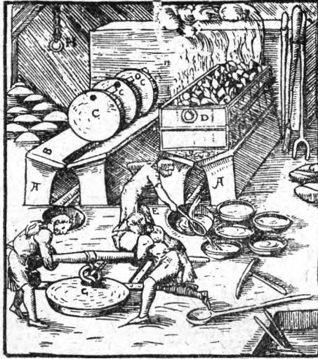
Rys. 14. Piec do odtapiania ołowiu bogatego od miedzi wg Erckera.
