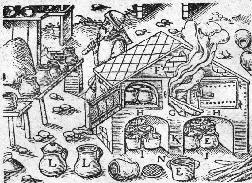
Rys. 2. Piec do wychwytywania siarki przy prażeniu rud siarczkowych wg Agricoli. Рис. 2. Печь для извлечения серы при обжиге сернистых руд (по Агриколи). Fig. 2. A furnace to isolate sulphur when reducing sulphuric ores after Agricola.
