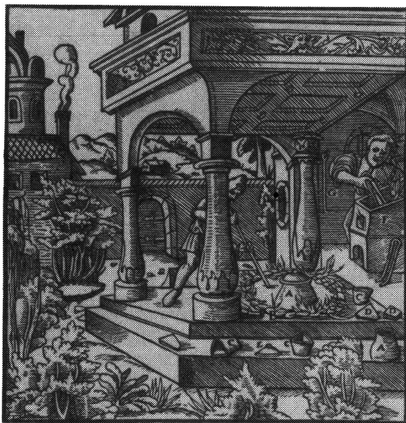
Ryc. 8. Piec do cementacji złota wg G. Agricoli; A — piec, B — naczynie, C — przykrycie naczynia, D — otwór wentylacyjny
