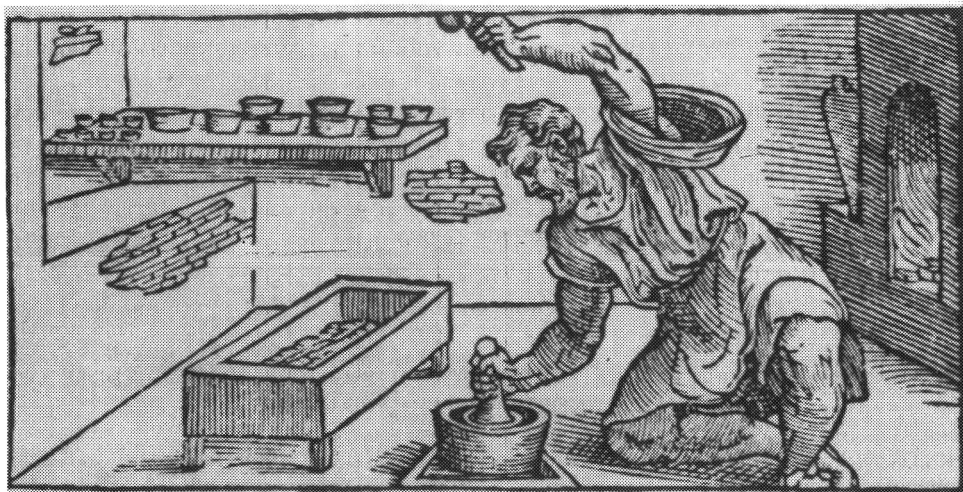
Ryc. 1. Wyrób tygli do kupelacji według V. Biringuccia
