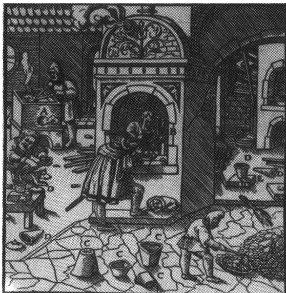
Ryc. 3. Rafinacja złota przy użyciu spizglasu tj. kamienia siarczkowego według G. Agricoli; A — piec z ciągiem naturalnym, B — piec do podgrzewania złota przy przekuwaniu, C — tygiel gliniany, D — forma żelazna do odlewania regulusu, E — podstawa
