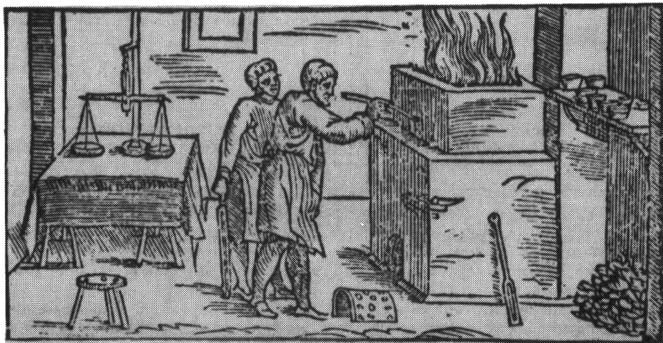
Ryc. 2. Laboratoryjny piec do kupelacji według V. Biringuccia
