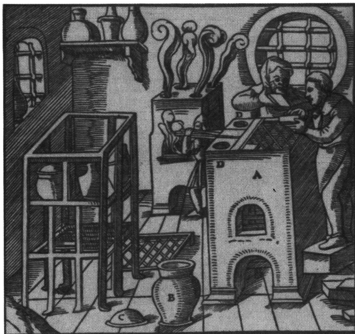
Ryc. 5. Rafinacja złota przy użyciu siarki według G. Agricoli; A — naczynie otoczone rozżarzonymi węglami, B, C — tygiel, D — pokrywa tygla, E — pokrywa naczynia, F — piec z naturalnym ciągiem, G — pogrzebacz
