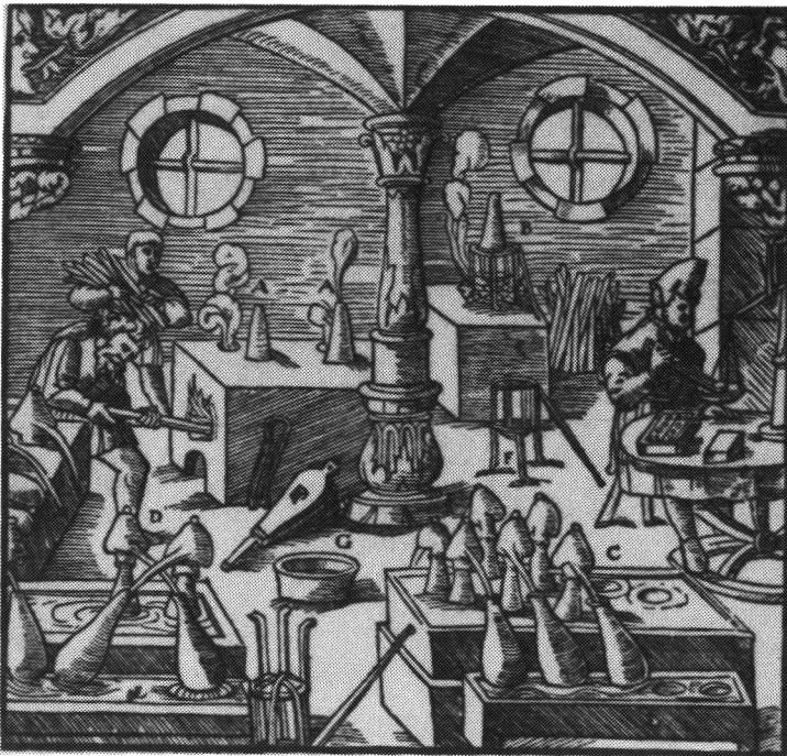
Ryc. 11. Wytworzenie kwasu azotowego według G. Agricoli; A — kolby szklane umieszczone w tyglach, B — kolba na stojaku żelaznym, C → kolby na łaźni piaskowej, D — kolby na łaźni piaskowej, E — podstawa na której znajdują się kolby, w których zbiera się kwas azotowy, F — trójnóg żelazny do podtrzymywania kolby, w której oddziela się niewielka ilość złota i srebra, G — tygiel
