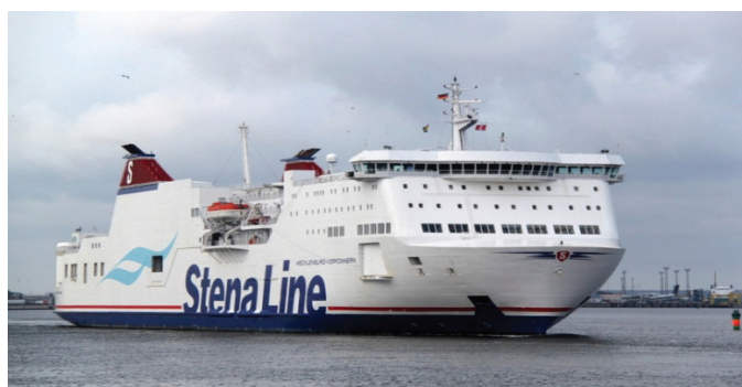
Rysunek 2. Prom typu ro-pax: Stena Mecklenburg-Vorpommern eksploatowany na trasie Rostock–Trelleborg (liczba pasażerów: 600, długość linii ładunkowej: 3100 m)
