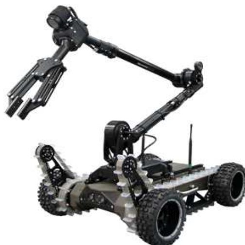
Rys. 6. Napęd kołowo-gąsienicowy na przykładzie urządzenia PIAP Gryf
