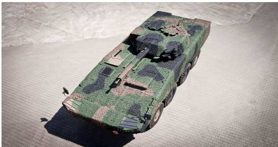
Rys. 3. Mobilne pokrycie maskujące KTO Rosomak
