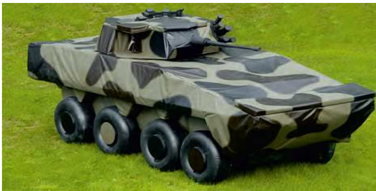
Rys. 4b. Makieta pneumatyczna KTO Rosomak: widok z góry makiety
