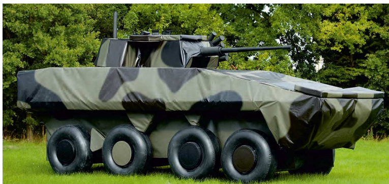
Rys. 4a. Makieta pneumatyczna KTO Rosomak: widok z boku makiety
