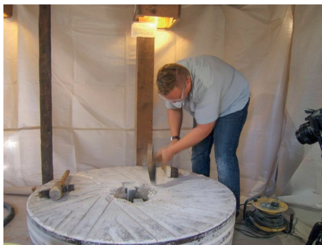
Fot. 2. Ostrzenie kamieni młyńskich. Autor dokonuje wyrównania powierzchni kamienia – bieguna pod okiem specjalisty – Johna Bedingtona
