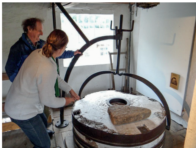
Fot. 5. Żuraw – stone crane do podnoszenia górnego kamienia młyńskiego – bieguna . Na ścianie widoczna tabliczka z jednym z bohaterów powieści J.R.R Tolkiena – element gry dla dzieci
