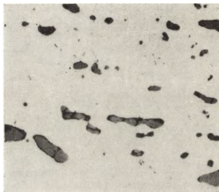
Ryc. 11. Wtrącenia żużla we fragmencie drutu z Radomia-Wośników, nie trawione (powiększenie 500 razy)
