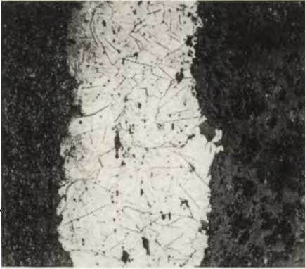
Ryc. 12. Struktura bransolety z Radomia-Wośników; ferryt, wydzielienia fazy A ( \gamma' - \text{Fe}_4\text{N} ?) i wtrącenia żużla, trawione azotalem (powiększenie 100 razy)
