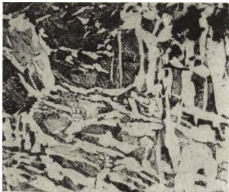
Ryc. 28. Struktura ostrogi ze Stoczyk, pow. Włoszczowa: perlit, ferryt i wtrącenia żużla, trawione azotalem (powiększenie 100 razy)
