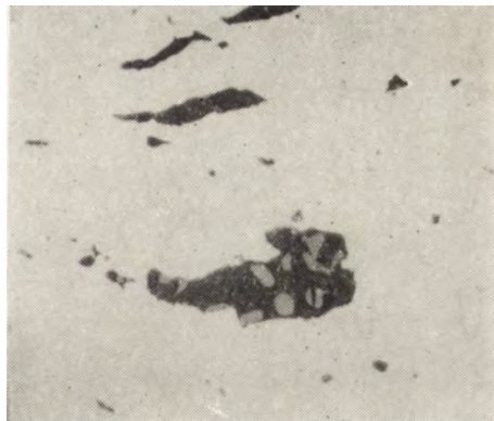
Ryc. 9. Wtrącenia żużla w kółku z Radomia-Wośników, nie trawione (powiększenie 500 razy)
