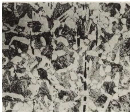
Ryc. 27. Struktura miecza z Niegosławic, pow. Jędrzejów: perlit, ferryt i wtrącenia żużla, trawione azotalem (powiększenie 100 razy)
