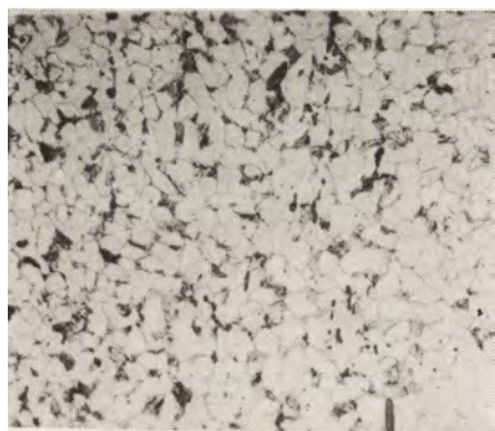
Ryc. 10. Struktura fragmentu drutu z Radomia-Wośników; ferryt, perlit i wtrącenia żużla, trawione azotalem (powiększenie 100 razy)
