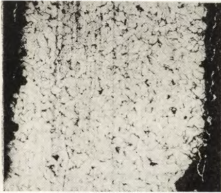
Ryc. 19. Struktura fragmentu nr 1 z Korytnicy: ferryt, ślady perlitu, wydzielenia fazy B ( \alpha'' Fe 16 N 2 ?) i wtrącenia żużla, trawione azotalem (powiększenie 100 razy)
