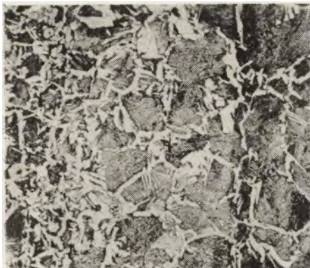
Ryc. 15. Struktura silniej nawęglonej części grota włócznie z Grójca: perlit, ferryt i wtrącenia żużla, trawione azotalem (powiększenie 100 razy)
