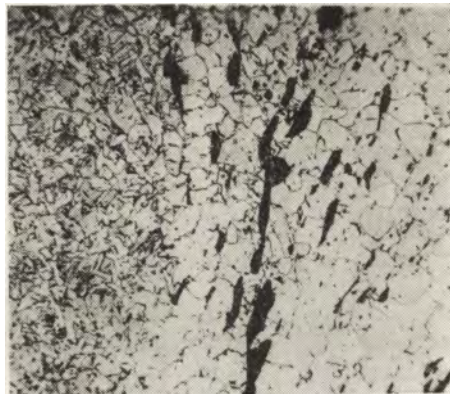
Ryc. 34. Struktura noża z Wąchocka, pow. Iłża: ferryt i wtrącenia żużla, trawione azotalem (powiększenie 100 razy)
