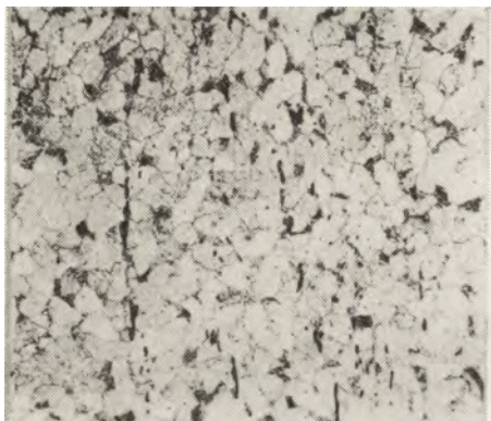
Ryc. 8. Struktura kółka z Radomia-Wośników: ferryt, perlit i wtrącenia żużla, triawione azotalem (powiększenie 100 razy)
