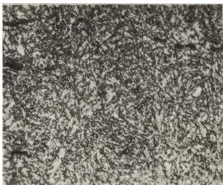
Ryc. 24. Struktura części silniej nawęglonej kluczyka z Korytnicy pod większym powiększeniem: sorbit (?) i wtrącenia żużla, trawione azotalem (powiększenie 500 razy)
