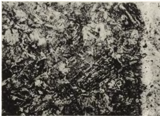
Ryc. 32. Struktura w nakładce stalowej noża z Piliicy, pow. Olkusz: troostyt iglasty (martenzyt ?) oraz zgrzeina (na prawo), trawione azotem (powiększenie 100 razy)
