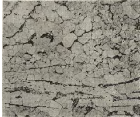
Ryc. 20. Struktura fragmentu nr 2 z Korytnicy: ferryt, perlit, wydzielenia fazy B ( \alpha'' —Fe 16 N 2 ?) i wtrącenia żużla, trawione azotalem (powiększenie 100 razy)
