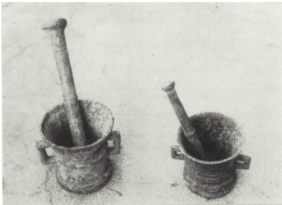
Ryc. 3. Moździerze żelazne odlane według tradycji w XVIII w. w Nowym Stawie i służące do tłuczenia kruszcu ołowiu i żużli żelaznych stosowanych przez łagowskich garncarzy do wyrobu glazur ceramicznych
