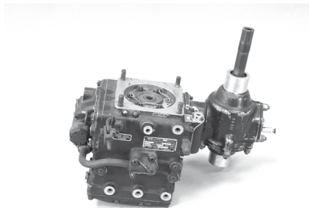
Przekładnia napędu podkadłubowej, kulistej, obrotowej wieżyczki strzeleckiej Sperry, tzw. „ball turret
