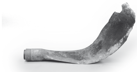
Łopata śmigła radzieckiego samolotu transportowego Lisunow Li-2
