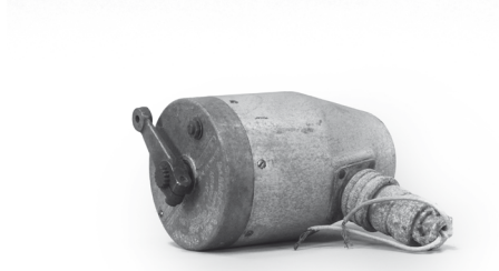
Mechanizm sterowania zaworu nadmiarowego dołotu powietrza do turbosprężarki silnika Wright R-1820-97
