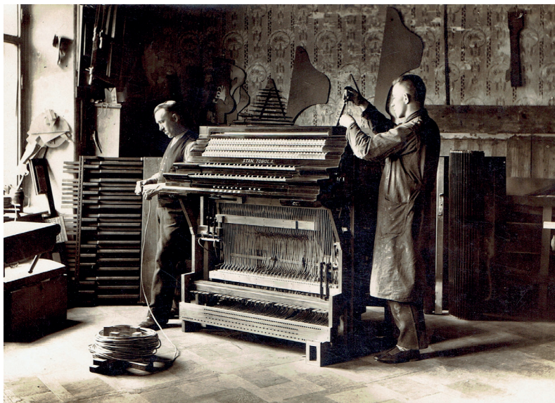
Ilustracja 3. Budowa kontuaru do kościoła klasztornego. Źródło: ACM, bez sygn., Remonty – początek XX w. – organy klasztorne ,teczka.
