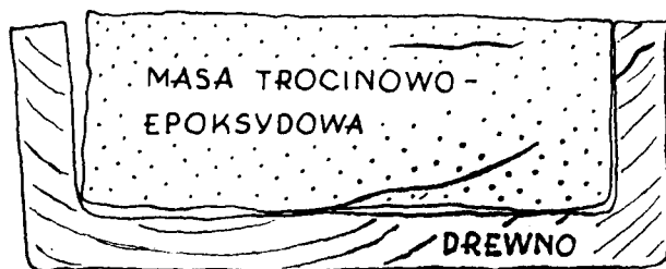
2. Przykład odspojenia kitu od drewna w wyniku działania zmiennych warunków wilgotności
