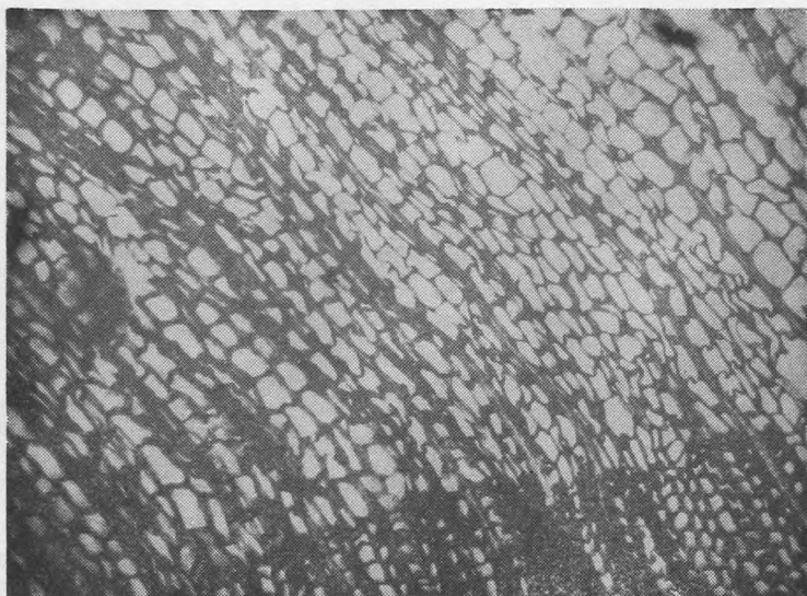
Fot. 2. Drewno archeologiczne ( Pinus silvestris ) — mikrofotografia preparatu ciętego z drewna wysuszonego. Widoczna silna deformacja komórek i sklejanie się ścian
