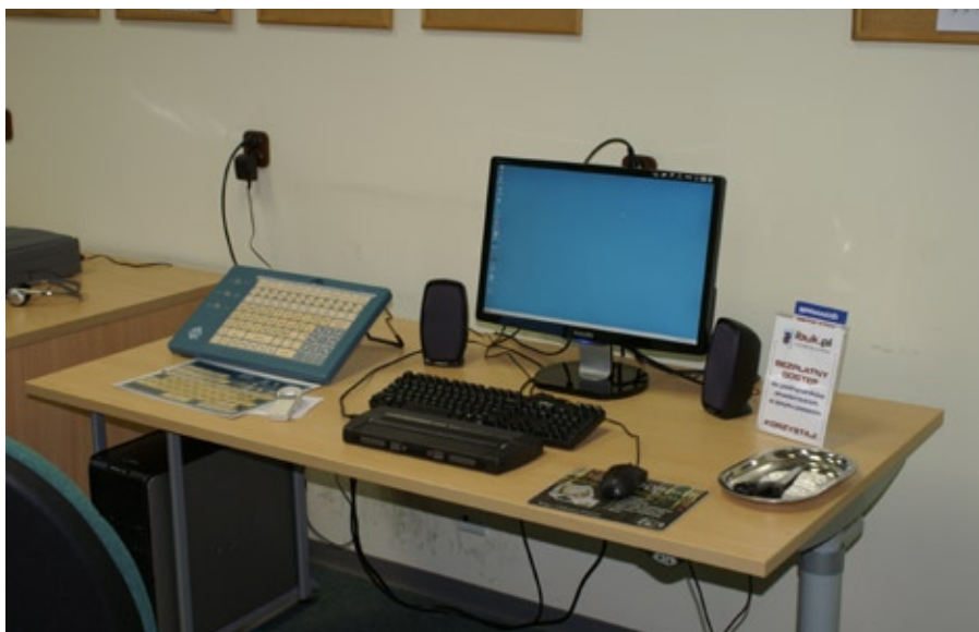
Stanowiska przystosowane dla osób niepełnosprawnych: – monitor i klawiatura Brailla oraz zestaw głośnomówiący,
