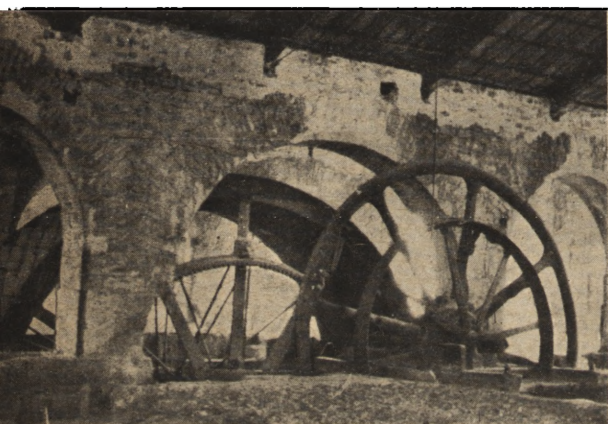
Ryc. 306. Sielpia Duża, pow. konecki — walcownia. Koło napędowe i koła zamachowe.
