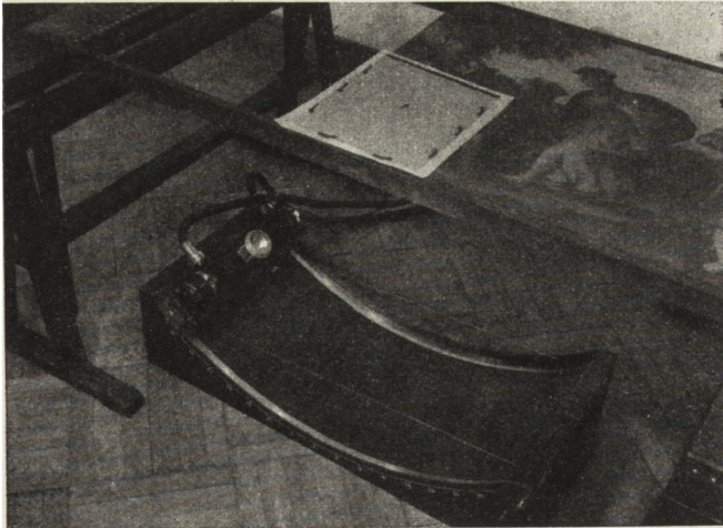
Ryc. 253. Aparat rentgenowski przesunięty za pomocą korbowodu na prawe stanowisko. Wskazówka pokazuje 38^\circ , czyli że kąt między promieniami środkowymi wyniesie 76^\circ . Na obrazie leży lekka tekturowa kasetka dla zdjęcia prawego.
