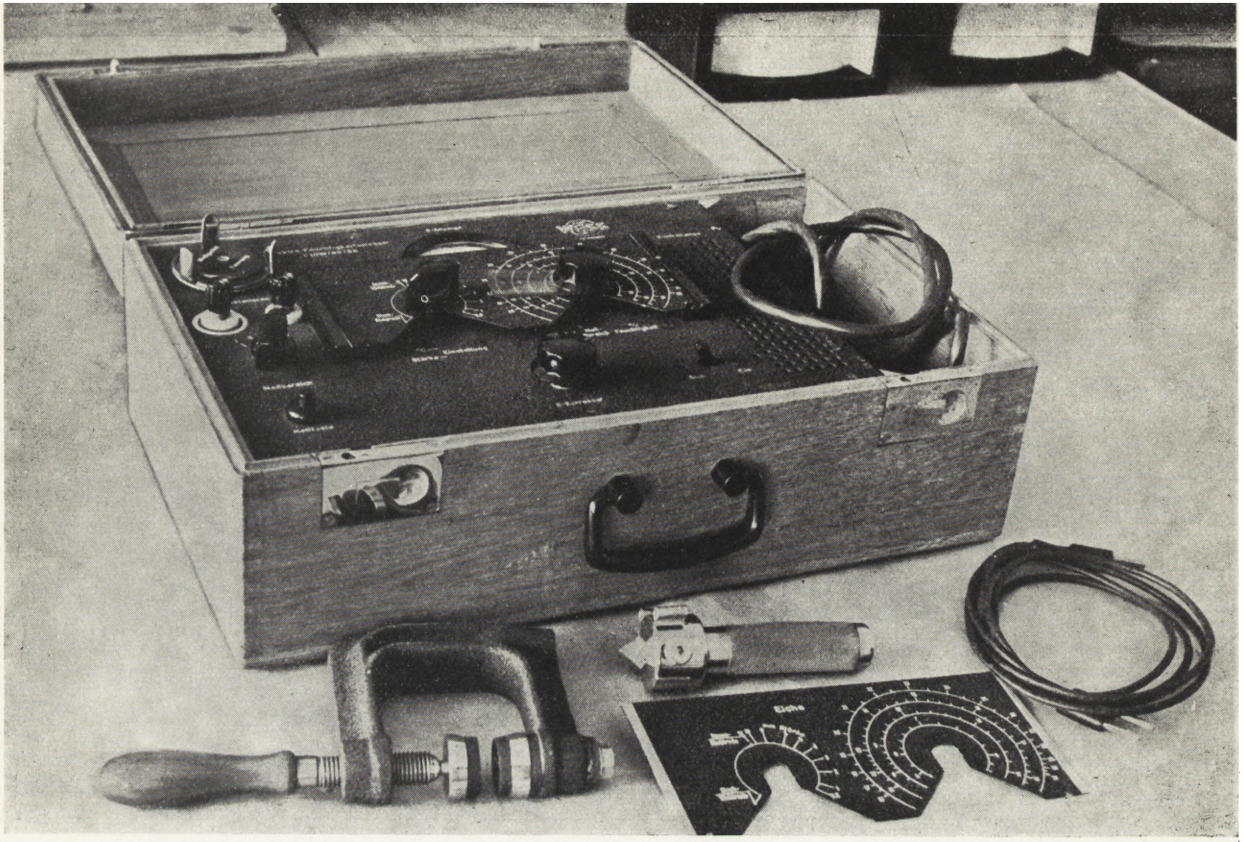
Ryc. 8. Ogólny widok niemieckiego wilgotnościomierza do drewna firmy K. Weiss. Na zdjęciu pokazane są również elektrody stykowe do cienkich desek lub sklejk, elektrody nożowe do wbijania w badany materiał i wymienna skala gatunku drewna (fot. autor)
