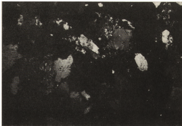
2. Zdjęcie mikroskopowe piaskowca arkozowego o spoiwie krzemionkowo-wapiennym pochodzącego z elementu autentycznego portalu. Powiększenie 90 X
