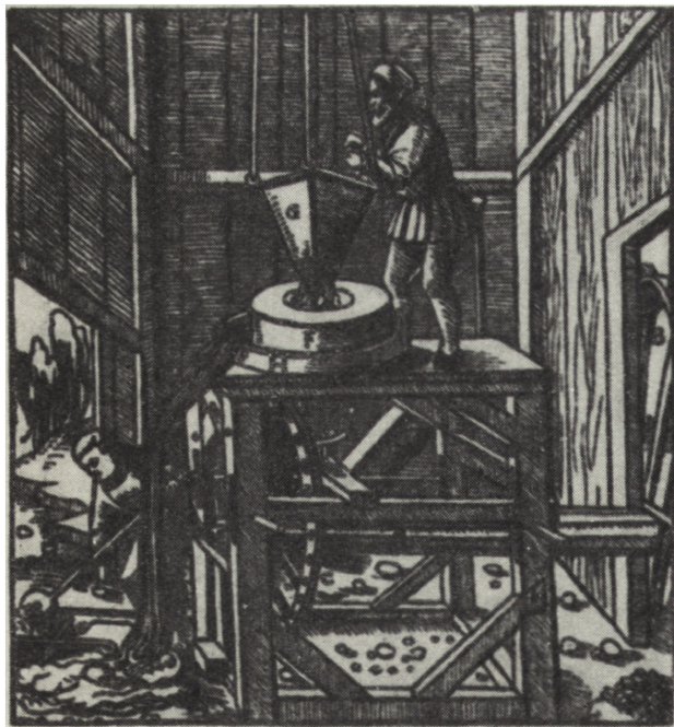
2 Średniowieczny młyn do mielenia kruszywa (drzeworyt z dzieła G. Agricoli „De re metalica”)
