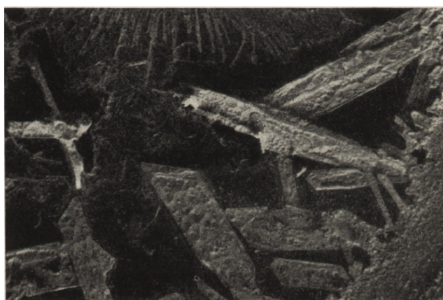
9. Kryształy \text{Na}_2\text{SO}_4 \cdot 10 \text{H}_2\text{O} otrzymane z 10% roztworu (fot. E. Wołujewicz)
