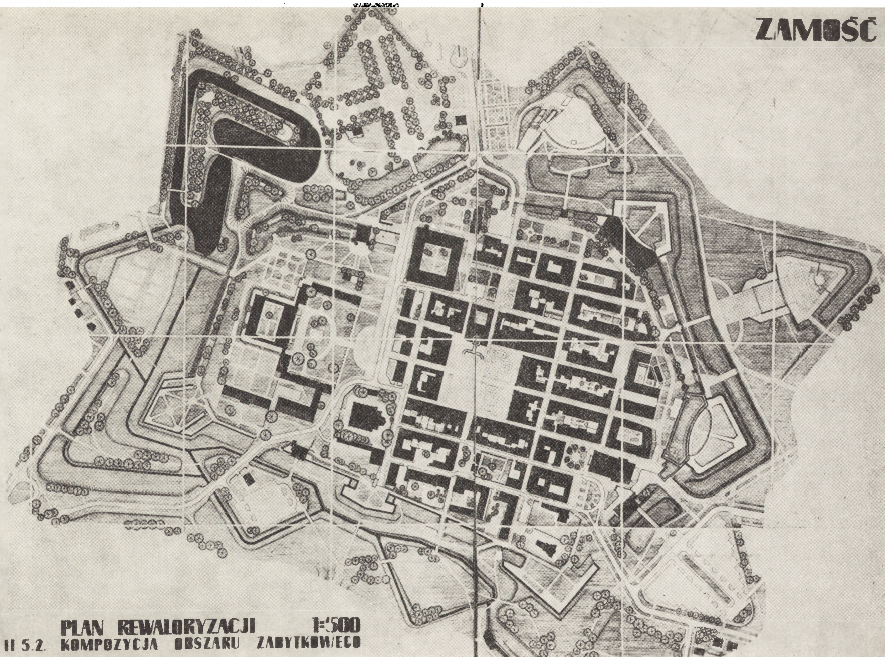
2. Makieta rysunkowa układu docelowego — kompozycja; technika wykonania: tusz na odbitce czarno-białej podkładu geodezyjnego (oprac. arch. W. Sobek i J. Szozda)
