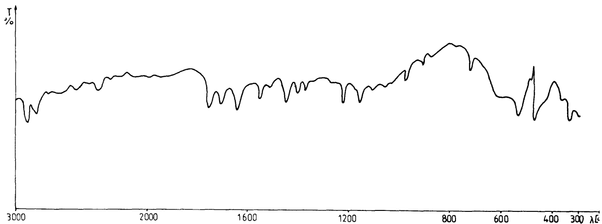
9. Widmo IR spoiwa temperowego z czerwienią żelazową 9. The IR spectrum of the tempera binder with iron red
