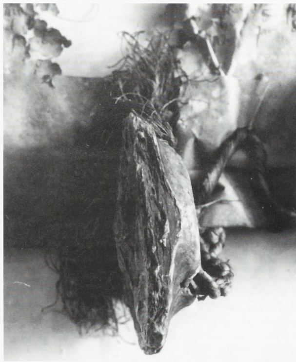
12. Zmiany struktury masy woskowej widoczne w postaci rozjaśnień, spękań i wykwitów przebiegające od powierzchni pieczęci ku jej wnętrzu (AP Wrocław, sygn. 3,510 f, 1337 r.). Fot. E. Jabłońska
