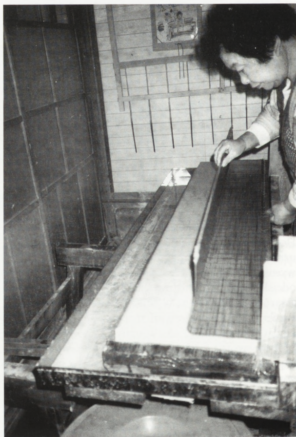
6. Zdejmowanie ruchomego sita z papieru w procesie wytwarzania papieru uda 6. The removal of the sieve from the paper during the production of uda paper
