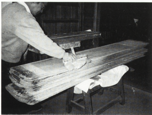
7. Wilgotne papiery dociskane są do drewnianych płyt za pomocą pędzla 7. Damp paper is pressed onto wooden plates with the aid of a paintbrush
