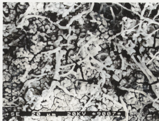
8. Wzrost nitkowatych form grzybów w strefie przypowierzchniowej wapienia
