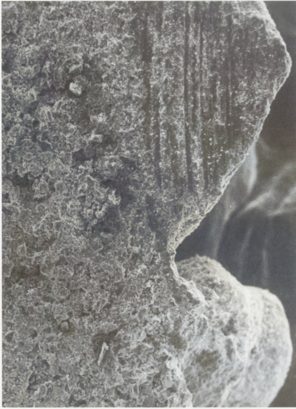
5. Rzeźba św. Jana Nepomucena — obraz linearnego przyrostu nawarstwienia i zdeintegrowanej struktury przypowierzchniowej obserwowany w mikroskopie skaningowym. Próba 5/2 — nawarstwienie i wylugowane partie pod jego powierzchnią powiększone 40x. Fot. R. Kopczyński
