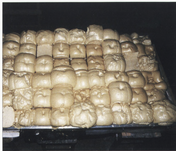
9. Odwrocie obiektu po spienieniu pianki poliuretanowej w komorach konstrukcji zastępczego podłoża nośnego. Stan w trakcie konserwacji. Fot. A. Trochimowicz 2000
