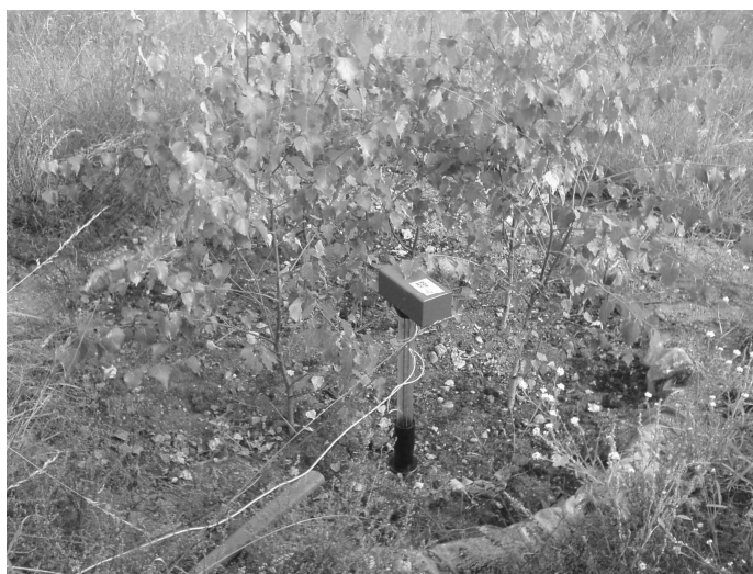
Rysunek nr 1. Bartington do wykonywania pomiarów magnetometrycznych gleb
