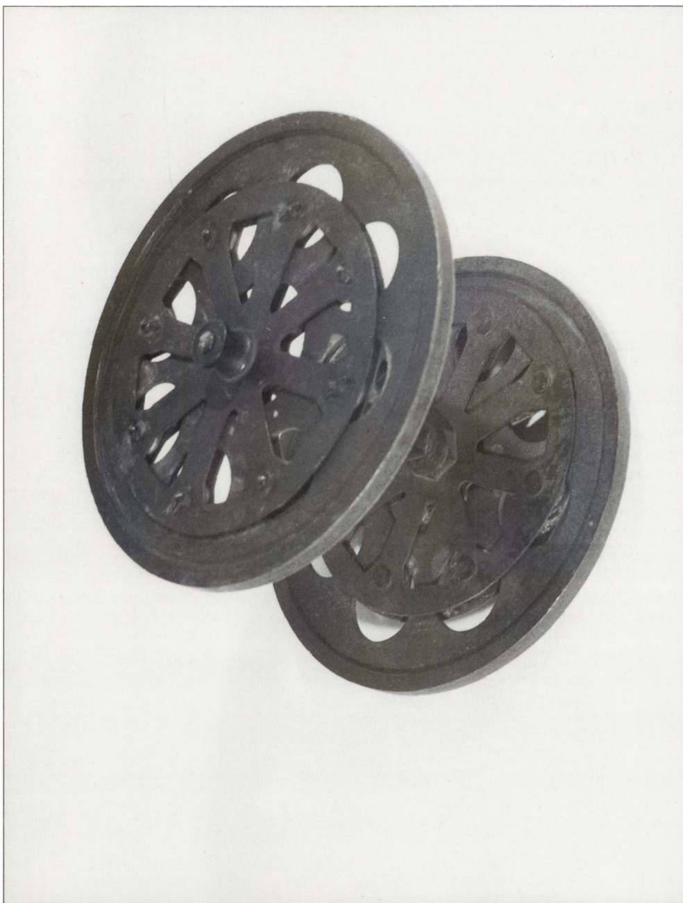
Fot. 4. Para kół, połączonych wspólną osią do pojazdu Józefa M. Hoene-Wrońskiego. Model ze zbiorów Muzeum Kórnickiego, MK 4123. Fot. jw. Oprócz możliwości poruszania się w pionie (po zamontowaniu do podwozia), koła te dzięki swojej konstrukcji mogą także samoistnie zmieniać położenie względem płaszczyzny poziomej.
