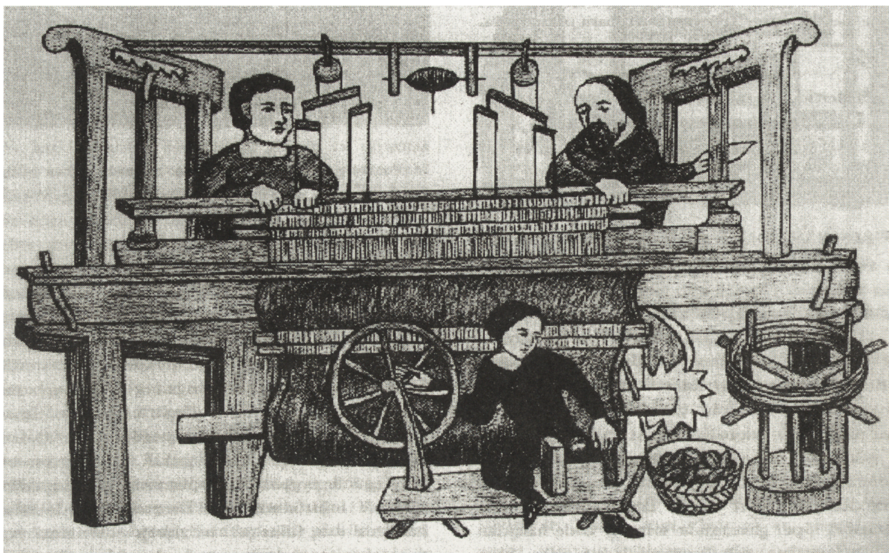
Ryc. 40. Krosno czteronicielnicowe z rękopisu Kuerboek z Ypern, 1363 r. (wg W. Endrei).
