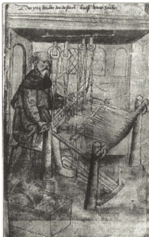
Ryc. 39. Krosno czteronicielnicowe z księgi Mendla, 1389 r. (wg F. M. Feldhaus).
