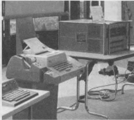
Ryc. 1. Minikomputer HP2114B z teledrukarką (teletype) ASR-33
