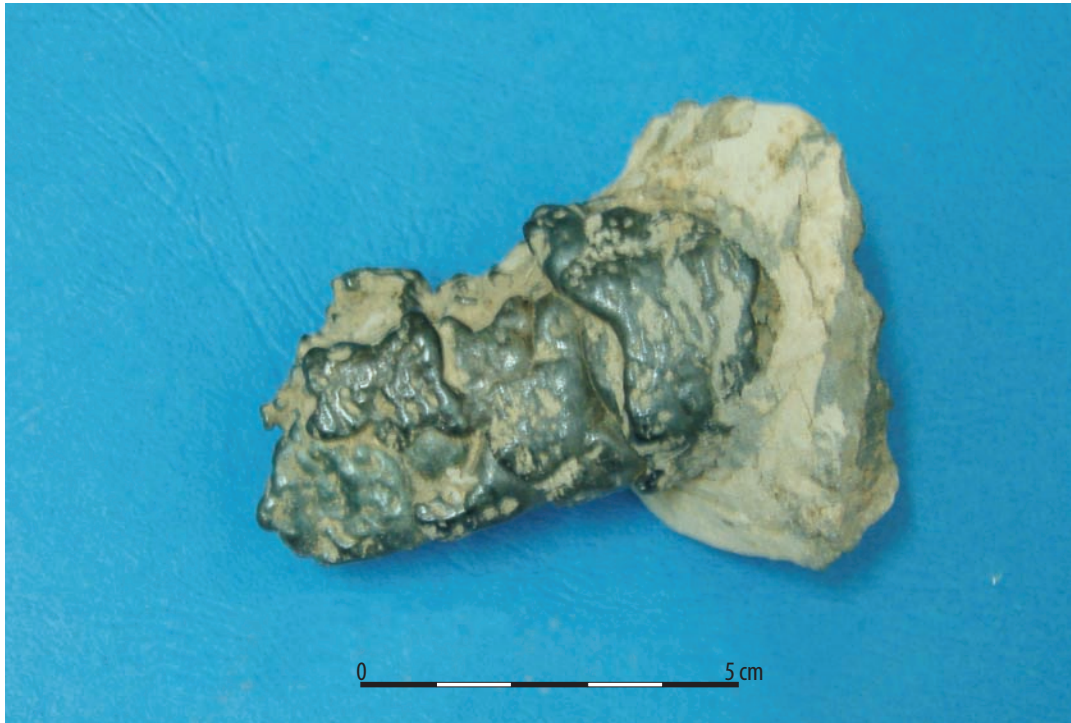
Ryc. 5. Chmielów, pow. ostrowiecki, stan. 4. Żuźlowy odlew okrągłego kanału kotlinkowego. Fot. A. Jedynak.
