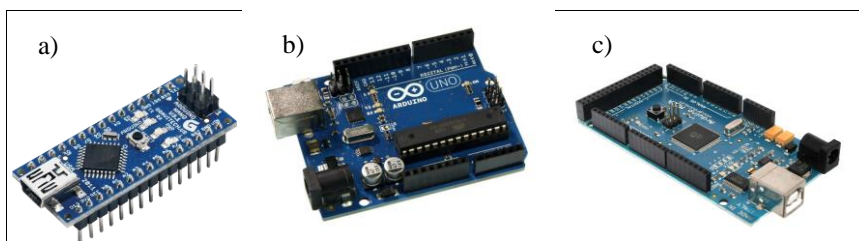
Rys. 2. Różne modele Arduino; a) Nano; b) Uno; c) Mega
